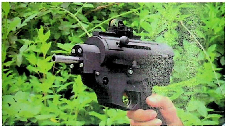
სურ. 116. პირველი 3D ბეჭდვითი 9 მმ ნახევრად ავტომატური პისტოლეტი
