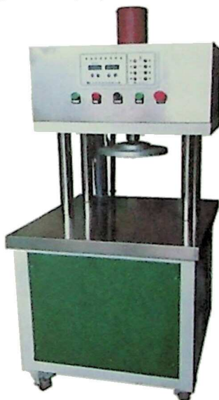
ნახ. 62 წნეხი ფილა ჩაის დამზადებისათვის (მწარმოებელი - ჩინეთი)
