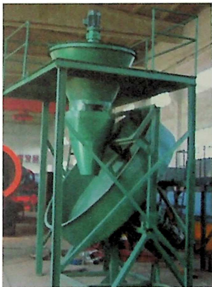
ნახ. 76 თეფშის მაგვარი გრანულატორი (მწარმოებელი - უკრაინა)
