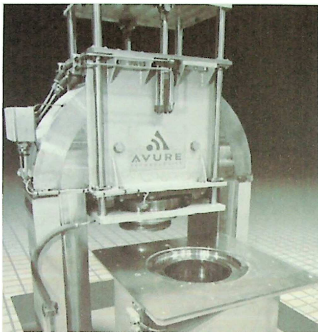
ნახ. 85 კვების პროდუქტების მაღალი წნევით დამუშავების საწარმოო სისტემა (მწარმოებელი - Avure Technologies -აშშ)
