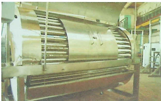
ნახ. 60 ხაჭოსა და რძის პროდუქტების ავტომატიზირებული წნებ-დანადგარი (მწარმოებელი რუსეთი)
