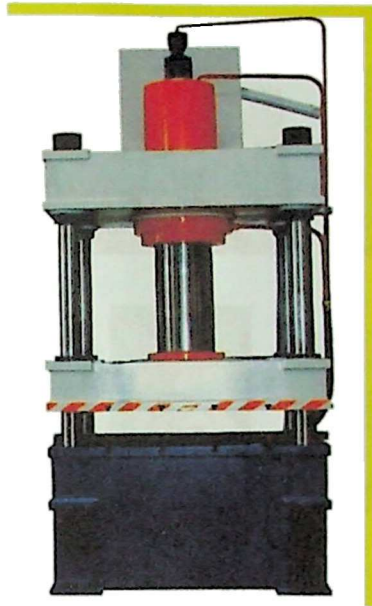
ნახ. 64 წნეხი ტაბლეტიებული ჩაის დამზადებისათვის (მწარმოებელი - ჩინეთი)
