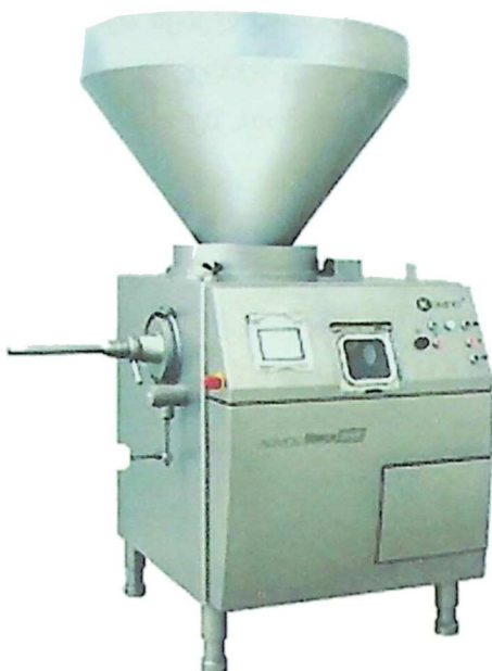
ნახ. 43 დაწნევის პრინციპზე მომუშავე შნეკიანი მექანიკური ჩასატუმბი დანადგარი (მწარმოებელი - „Buder“)
