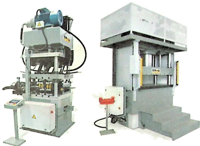
ნახ. 74 ბრიკეტირებული მშრალი ხილის წარმოებაში გამოყენებული ოთხკოლონიანი ჰიდრავლიკური წნეხი (მწარმოებელი AMOB SA)
