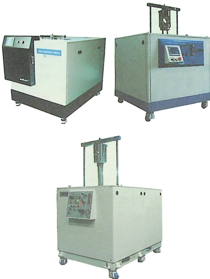
ნახ. 84 იზოსტატიკური დაწნევის თანამედროვე მოწყობილობები (მწარმოებელი - „Ishin Autoclave“)
