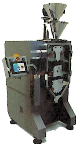
ნახ. 71 კვების პროდუქტებისა და ფარმაცევტული პრეპარატების ტაბლეტირებასათვის განკუთვნილი უნივერსალური მანქანა (მწარმოებელი „Comasa“)
