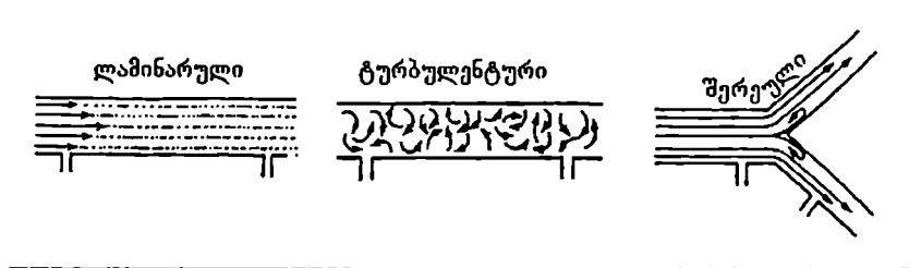
სურათი 120 აირის ლამინარული და ტურბულენტური ნაკადი
