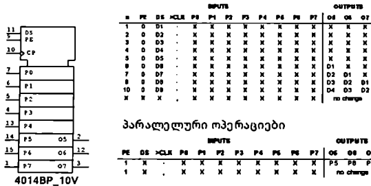
ნახ.62.3. რვა თანრიგის სრულად სინქრონული რეგისტრი 4014 და ოპერაციების შესრულების პარამეტრები
